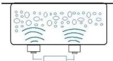
Ultrazvukové čištění je založeno na kavitaci, která vzniká působením vysokofrekvenčního vibračního signálu ultrazvukových vln v kapalině. Vytvářejí se mikroskopické bubliny, které násilně implodují, což způsobuje kavitaci a intenzivní drhnoucí účinek na povrchu čistěného předmětu. Bubliny jsou dostatečně malé, aby pronikly do mikroskopických štěrbin, které důkladně a konzistentně čistí.
