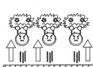
Nečistoty se rozdělí na malé částice, oddělí se od povrchu předmětu a vstoupí do vody.
