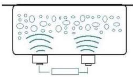
Ultrazvukové čištění je založeno na kavitaci, která vzniká působením vysokofrekvenčního vibračního signálu ultrazvukových vln v kapalině. Vytvářejí se mikroskopické bublinky, které násilně implodují, což způsobuje kavitaci a intenzivní drhnoucí účinek na povrchu čištěného předmětu. Bublinky jsou dostatečně malé, aby pronikly do mikroskopických štěrbin, které důkladně a konzistentně čistí.
