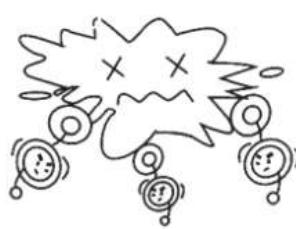
Pod působením ultrazvukové vlny bublinky neustále "explodují" a odstraňují nečistoty z povrchu objektu.
